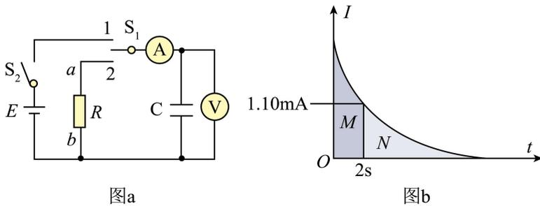
(1) 闭合开关  $S_2$ , 将  $S_1$  接 1, 电压表示数增大, 最后稳定在 12.3V。在此过程中, 电流表的示数\_\_\_\_\_ (填选项标号)
